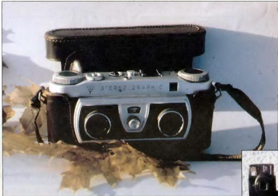
▲ Diese "Wray Stereo Graphic" ist eine 3D-Kamera mit zwei Objektiven und zwei gleichzeitig auszulösenden Verschlüssen. Der englische Lizenzbau eines US-Patents wurde zwischen 1956 und 1962 in einem Werk südöstlich von London hergestellt, aus dem ansonsten hauptsächlich Ferngläser kamen. Mit dieser Kamera habe ich etliche der 3D-Fotos in diesem Heft angefertigt. Trotz ihres eigentlich auch schon ehrwürdigen Alters zählt sie zu den (seltenen) "modernen" Stereokameras
